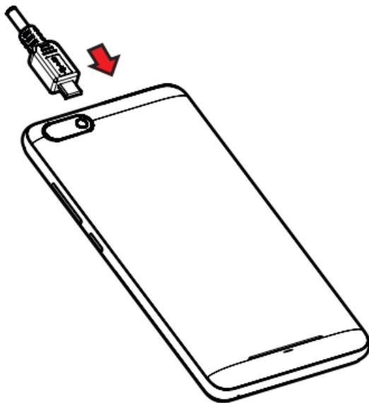
**Заряжать батарею можно с помощью зарядного устройства, или подключив смартфон к ПК через кабель USB.**
